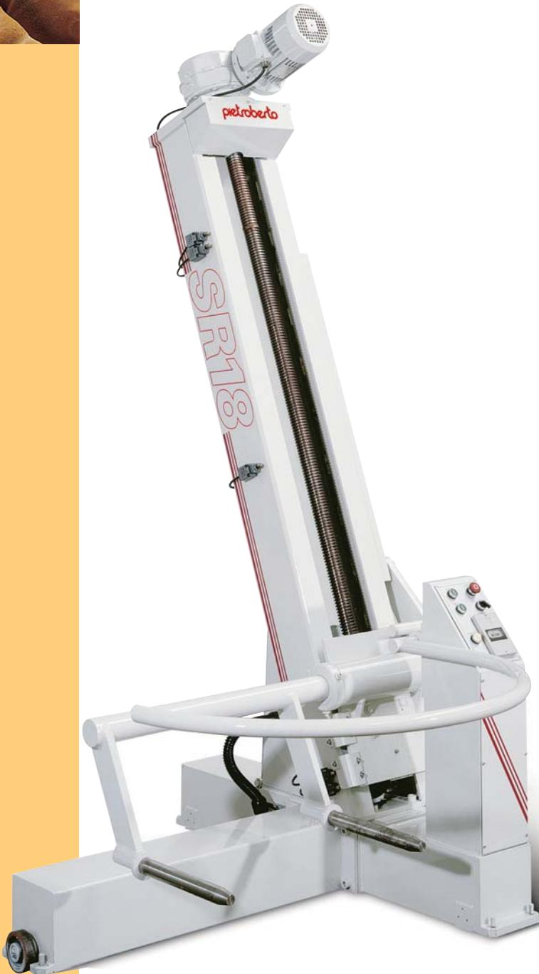
Struttura di nuova concezione che permette di rovesciare perfettamente, senza bisogno di scivolo, le vasche di qualsiasi tipo di impastatrice e le bacinelle delle planetarie.
